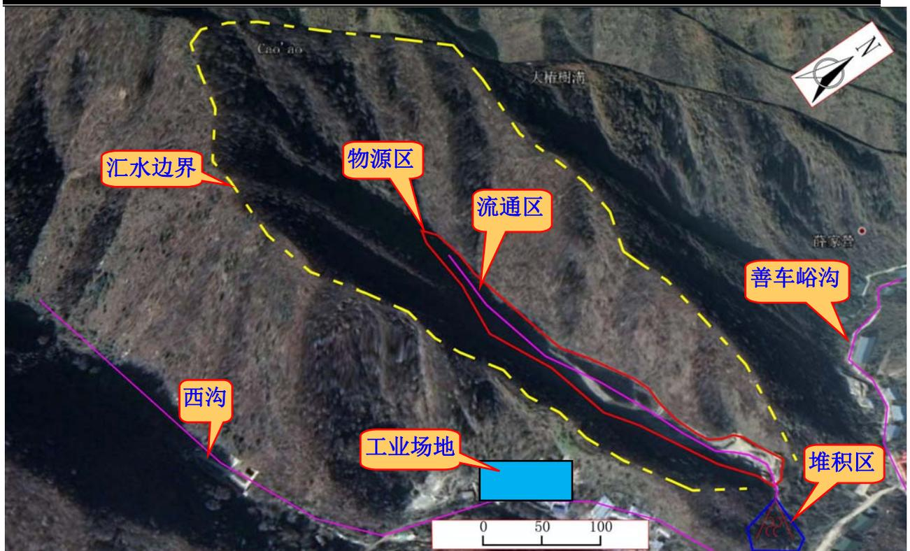
图 3-2 王林沟泥石流隐患平面图
