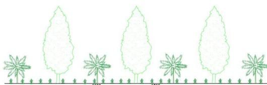
图 5-3 植被重建工程断面图（乔灌草结合）
